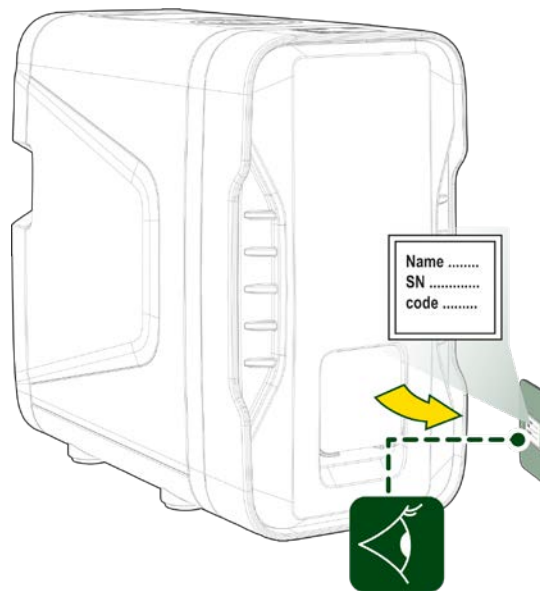
Fig. 4 Metalen plaatje - Positie label basisinformatie product
