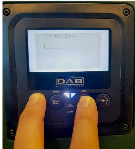
الشكل C9 - الوصول إلى "Loader" لتحديث "e.sybox"
