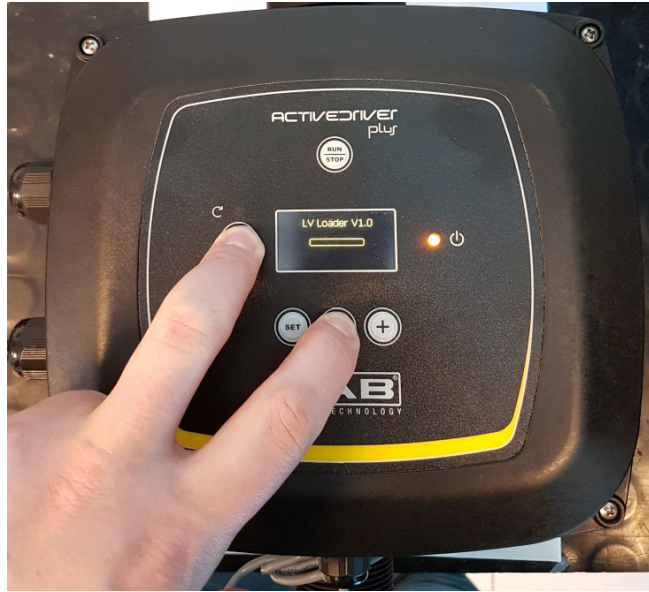
الشكل B9- مثال على تحديث "Sw 1.X" Active Driver Plus
