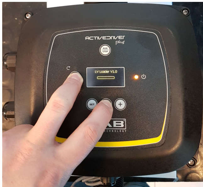
Figura 9B - Aggiornamento Active Driver Plus Sw 1.X
