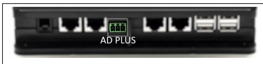
Figura 9A – Posizione connettore nel AD plus e nel DConnect Box, es. collegamento cavo dritto can-bus, nome connettore DConnect Box per collegamento con AD plus
